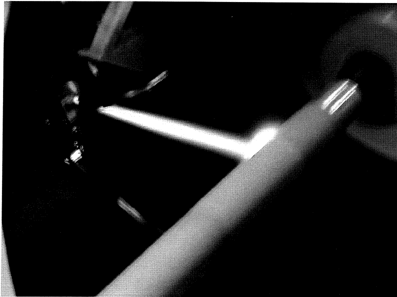
Fig. 3 : The H.V.O.F. process
